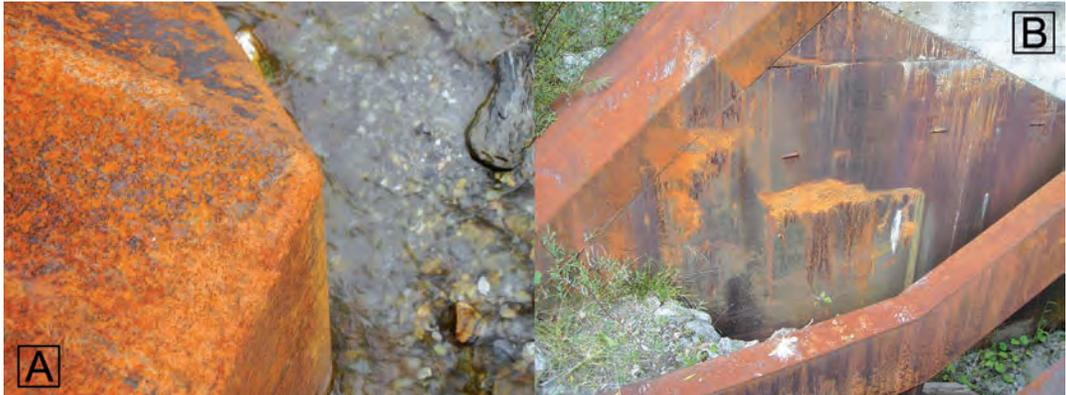
Abb. 23: Korrosion von Baustahl (Sauerstoffkorrosion): (A) Flächen- bzw. Muldenkorrosion; (B) verstärkte Stahlkorrosion in Abrasionsbereichen
