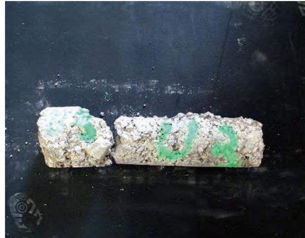
Abb. 4: Bohrkern aus der Bogensperre bei hm 15,93 am Schlossbach, Gemeinde Zirl, geringe Festigkeit
