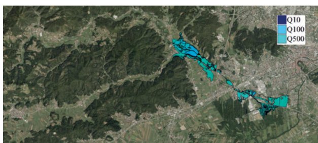
Slika 3: Izbrano računsko območje s kartami poplavne nevarnosti za Q10, Q100 in Q500 za stanje pred izvedbo ukrepa (zgoraj) in po izvedenem ukrepu (spodaj).
