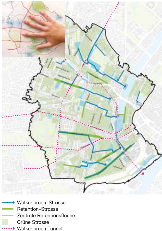
Abb. 16: Der «Fingerstrukturplan» zeigt auf, wie das Wasser bei Starkniederschlag abfließt.
