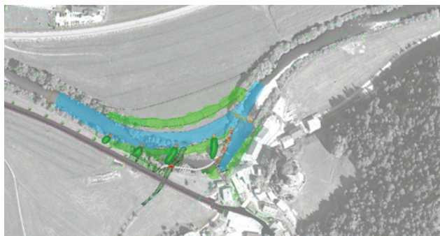
Slika 7: Izboljšanje hidravličnih razmer na območju Hotovlje s korekcijo krivine Poljanske Sore in izliva hudournika Hotoveljska grapa.
