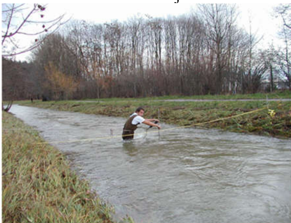
Slika 11 – Merjenje pretoka s 3D sondo
