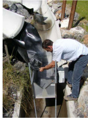
Slika 10 – Merjenje pretoka s trikotnim prelivom
