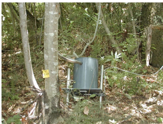
Slika 18 – Meritve odtoka po deblu na eksperimentalnem porečju Dragonje
